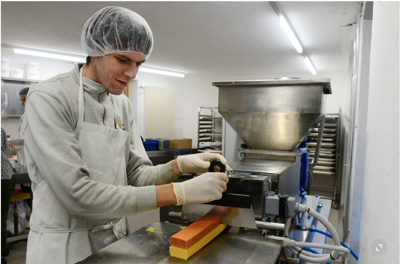
Severin Streich schneidet die Seife, die aus dem Extruder kommt, in Blöcke.
